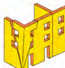
شکست گوشه به علت ترکیب شکست های برشی و خمشی
