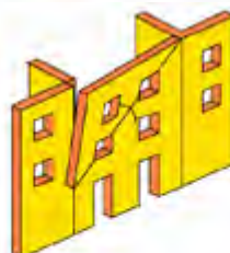
واژگونی و شکست جزئی از دیوار
