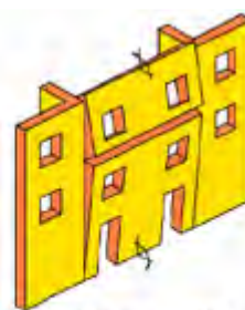
شکست خمشی برون صفحه به علت ایجاد ترک افقی و ایجاد یک قوس قائم
